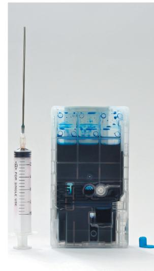
3 После заправки, заправочное отверстие в картриidge необходимо закрыть силиконовой пробкой, а воздушное отверстие открыть, сохранив пробки, на случай дальнейшей транспортировки принтера с установленными ПЗК.
