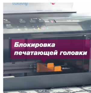
2 Откройте переднюю крышку принтера и извлеките блокировку печатающей головки.
