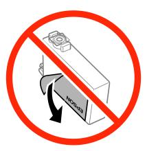
□ Не снимайте прозрачную изоляционную прокладку с нижней части картриджа, в противном случае картридж нельзя будет использовать.
